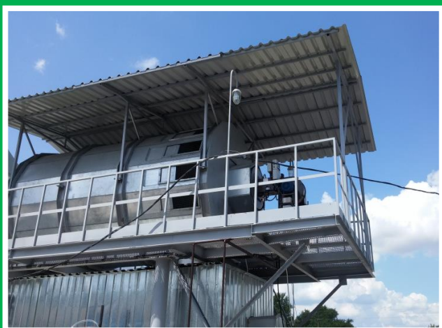
ВСТАНОВЛЕННЯ ПАЛЬНИКІВ PERIFLAME ТА МОДЕРНІЗОВАНИХ КАМЕР ЗГОРЯННЯ НА АМЕРИКАНСЬКІ ЗЕРНОСУШАРКИ MATHEWS
