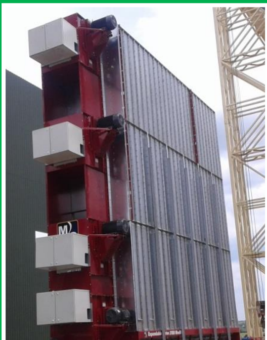
ВСТАНОВЛЕННЯ ПАЛЬНИКІВ PERIFLAME ТА МОДЕРНІЗОВАНИХ КАМЕР ЗГОРЯННЯ НА АМЕРИКАНСЬКІ ЗЕРНОСУШАРКИ MATHEWS
